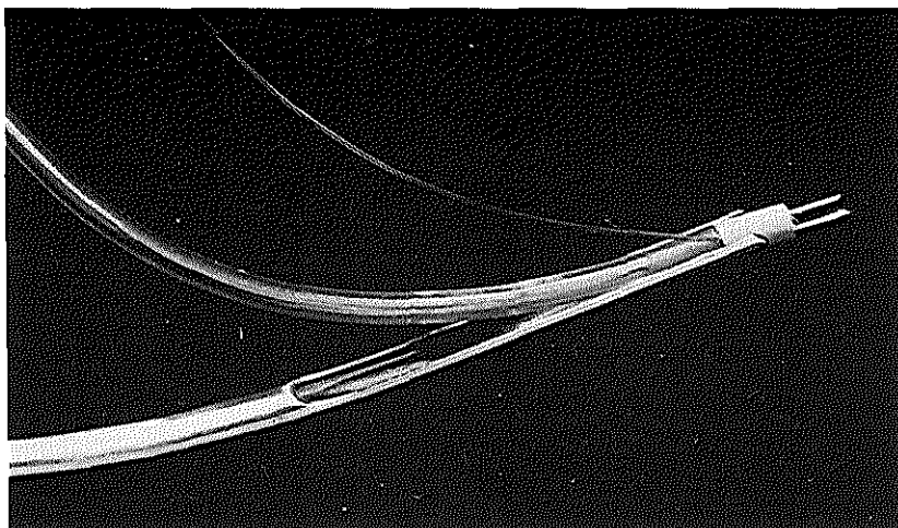
Fig.3.1. De gebogen holle invoersonde met mandrijn en de naaldelectroden.
