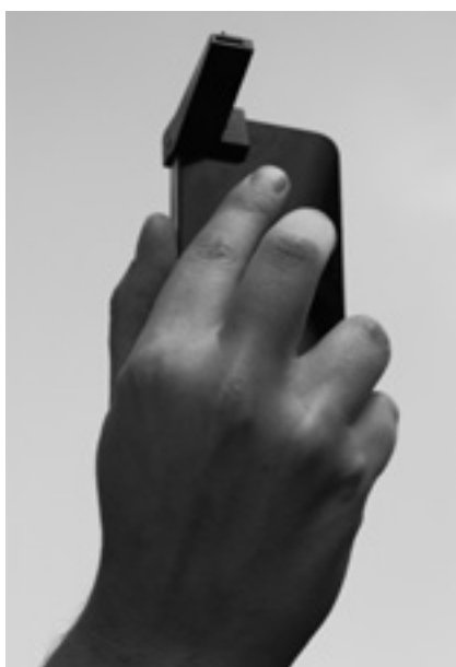
Figuur 3-5: Foto: ispex opzetstuk voor luchtvervuilingmeting via smartphones (Bron: isPEX).
